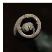
Resultado: HeBoCoat® welding previene la acumulación de proyecciones de soldadura en las boquillas de soldadura así como el bloqueo de la alimentación del hilo.
